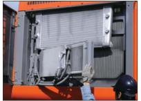
Конденсатор воздушного кондиционера и охладитель топлива можно открыть, что облегчает чистку самого конденсатора, а также расположенного за ним радиатора.
