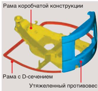
Новая рама коробчатой конструкции имеет небольшой вес и высокую надежность. Утяжеленные противовес и ходовая часть смещают вниз центр тяжести, что повышает устойчивость машины.
