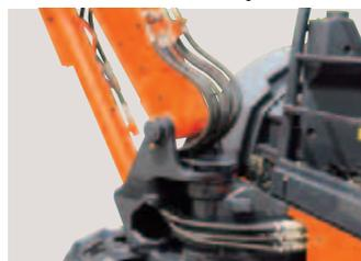
Секционные передние шланги присоединены к портам передней панели машины и к задней части стрелы для упрощения их замены.
