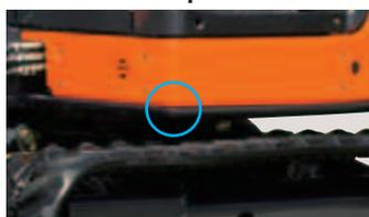
Рама машины усилена рамой с D-сечением, защищающей от повреждений и препятствий.
