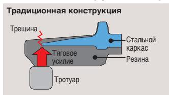
Разработанные Hitachi долговечные обрезиненные гусеницы имеют стальной каркас, защищающий от повреждения края башмака даже при движении по бордюру.
