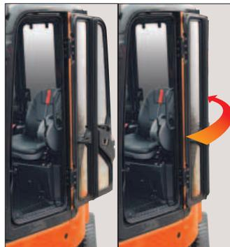
Дверь открывается двумя движениями и для удобства входа имеет увеличенную ширину 610 мм.
