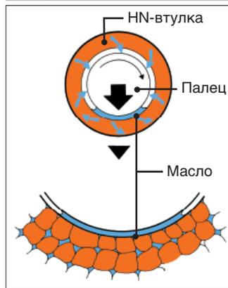
Конструкция втулки HN – это еще один пример новой технологии, разработанной Hitachi, которая обладает высокой надежностью и длительным сроком службы. Методом вакуумной пропитки вязкое масло попадает в промежутки между спеченными частицами прочного металла. Во время работы масло медленно вытекает из пор втулки и попадает в зазор между пальцем и втулкой, тем самым обеспечиваются условия для самосмазки.
