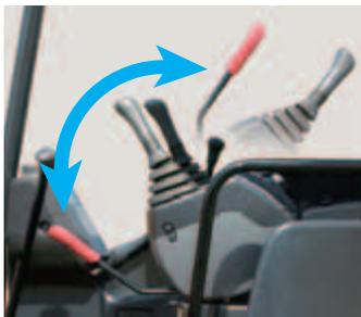
Все виды операций – передние, поворотные, ходовые и отвальные – могут быть остановлены блокированием клапана системы управления. Это эффективно защищает от нежелательных движений рычага управления.
