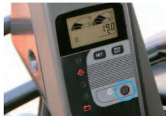
На нейтральной передаче скорость машины снижается до скорости холостого хода для сокращения расхода топлива и снижения шума и уровня выбросов в атмосферу. Это особенно важно при работе в жилых городских районах.
