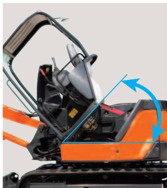
Пол кабины можно поднять для проведения быстрого простого технического обслуживания даже в экстренных случаях. Пол можно поднять на угол не более 50°, что позволит оператору работать под кабиной. Это также облегчает доступ к поворотному механизму и стартеру, расположенному за двигателем под полом кабины. Такая конструкция уменьшает время, необходимое для проведения технического обслуживания.
