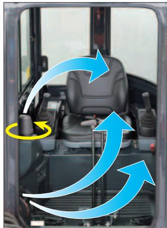
Стандартный кондиционер воздуха: компактный и многофункциональный. Воздуховыпускное отверстие кондиционера с возможностью поворота на 360° может также служить обогревателем, обеспечивая комфортные условия работы в любое время года.
