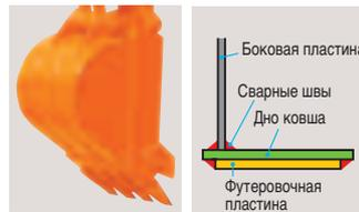
Ковш имеет стандартную конструкцию с плоским дном для уменьшения износа. Широкие футеровочные пластины приварены к дну ковша для повышения износостойкости.
