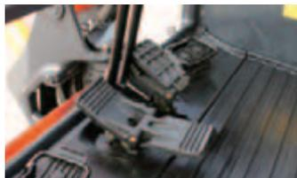
При управлении движением ножными педалями оператор может вручную управлять передним навесным оборудованием. Ножные педали при необходимости можно убрать для увеличения пространства для ног.
