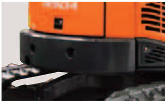
При использовании тяжелого переднего навесного оборудования (например, вилочного захвата) можно легко установить дополнительный противовес для повышения устойчивости.
