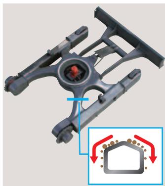
Горизонтальная балка рамы гусеницы имеет закругленную форму для облегчения очищения ее от грязи. Односторонний наклон боковой рамы гусеницы упрощает соскальзывание грязи и освобождает от проблемы ее накопления. Это также снижает стоимость и время для мытья машины.
