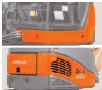
Специально для тяжелых операций используется стальная крышка, которую в случае повреждения можно легко отремонтировать. Стальная крышка является износостойкой, экономичной и подлежит вторичной переработке.
