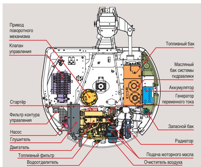
ZAXIS40U и ZAXIS50U имеют одну и ту же конструкцию для удобства осмотра и замены деталей. Точки осмотра расположены в одном месте для быстрого ежедневного обслуживания.
