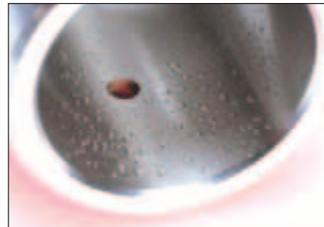
Оригинальные проверенные в работе HN-втулки Hitachi установлены во всех шарнирных соединениях передней части машины для уменьшения подергивания и необходимости в обслуживании. Интервал смазки увеличен до 500 часов.
