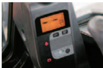
Оператор всегда может с одного взгляда оценить состояние машины. Уровень топлива, температура охлаждающей жидкости и другие параметры отображаются на ЖК-мониторе, расположенном впереди справа.
