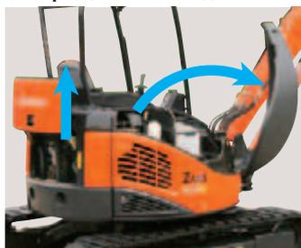
Крышка двигателя может скользить вверх и вниз для быстрого обслуживания в ограниченном пространстве. Откидывающиеся крышки, которые затрудняют обслуживание и ремонт, уже не используются. Правая крышка может откидываться для быстрой проверки состояния аккумулятора.
