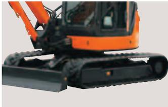
При движении на большой скорости, когда возрастает нагрузка, например, на рулевое управление, скорость движения постепенно и автоматически уменьшается. При уменьшении нагрузки скорость движения соответственно возрастает.
