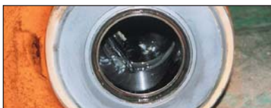
Термическое напыление WC
