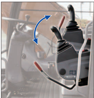
Рычаг блокировки системы управления
